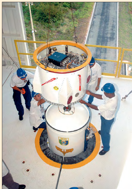
Отсек системы управления, которую считают одной из виновниц аварии
