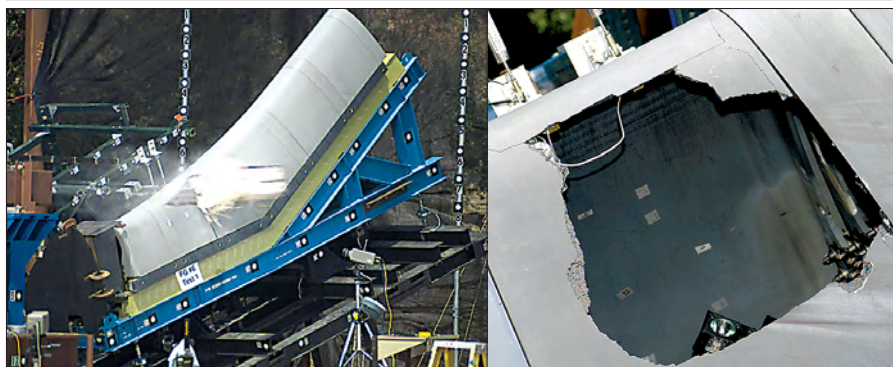
Стенд в момент испытаний и разрушения, произведенные куском пеноизоляции
