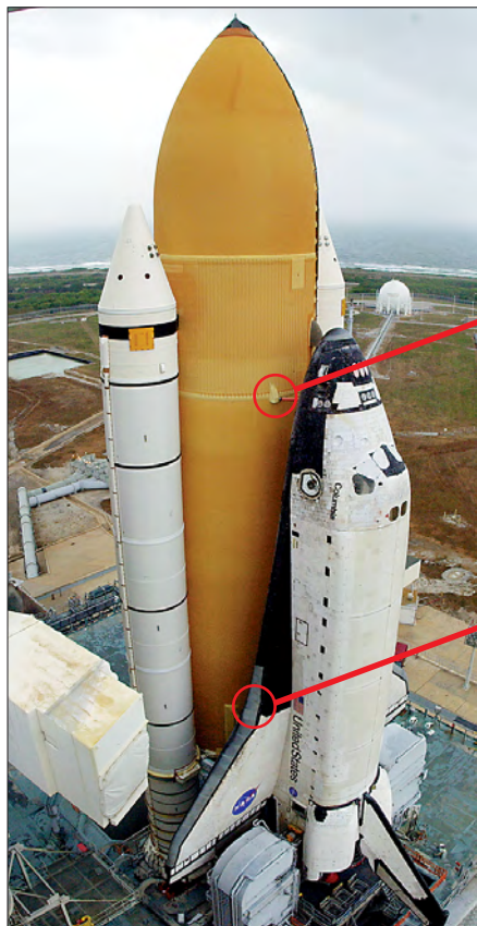
Вверху: отсюда сорвался злосчастный кусок пены Внизу: наиболее вероятная траектория соударения
