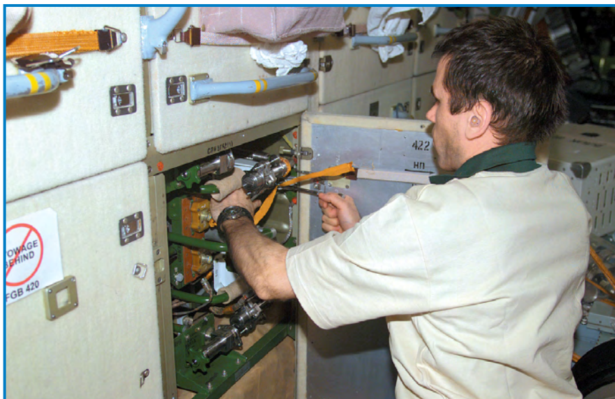
Юрий Маленченко занимается системой терморегулирования в ФГБ
