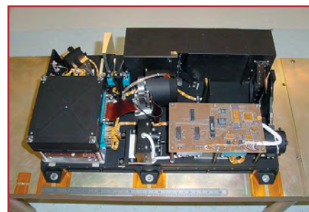
Спектрометр для исследования атмосферы методами солнечного и звездного просвечивания SPICAM (со снятой крышкой).
