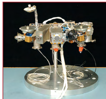
Газоанализатор посадочного модуля Beagle 2
