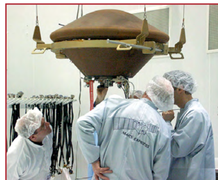
Заключительные операции с посадочным зондом в МИКе космодрома Байконур
