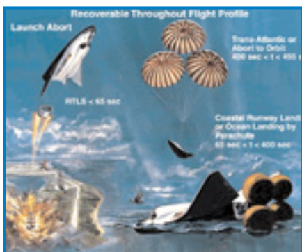
Система аварийного спасения для космоплана должна работать на всем активном участке выведения
