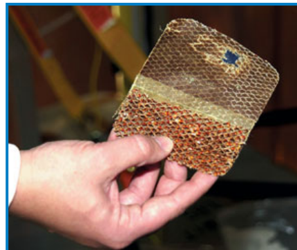
Поврежденная сотовая панель манипулятора
