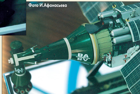
Макет функционально-грузового блока (ФГБ) транспортного корабля снабжения (слева), иллюстрирующий расположение полезных грузов. Внизу справа – макет передней части ТКС с возвращаемым аппаратом, топливными баками, ДКС и приводными поворотами солнечных батарей
