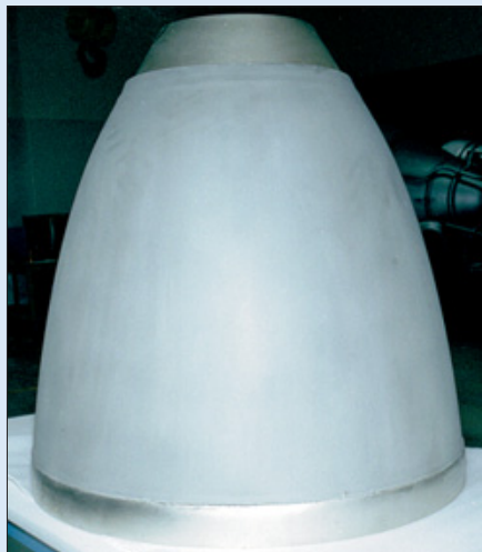
Сопло двигателя COBRA, в масштабе 40% от натурального
