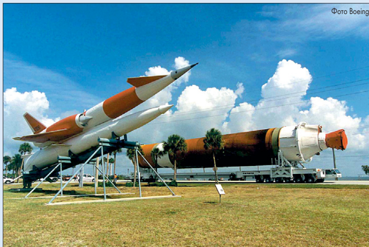
Вывоз центрального блока «Дельты-4». На переднем плане – исторический экспонат – дальняя сверхзвуковая крылатая ракета Navajo
