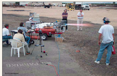
Испытания двигателя на мобильном огневом стенде
