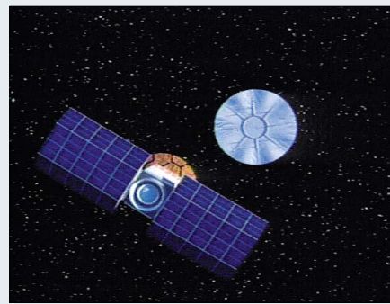
Сверхлегкий парус, который мог бы приводить в движение космический аппарат для межзвездных исследований. Парус получает энергию от луча, генерируемого спутником с солнечной энергоустановкой. Спутник преобразовывает энергию в микроволновый или лазерный луч, направленный на парус. Рисунок NASA
