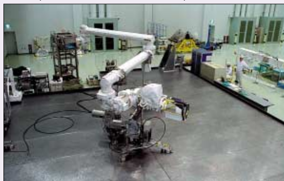
Испытания главной «руки» манипулятора
