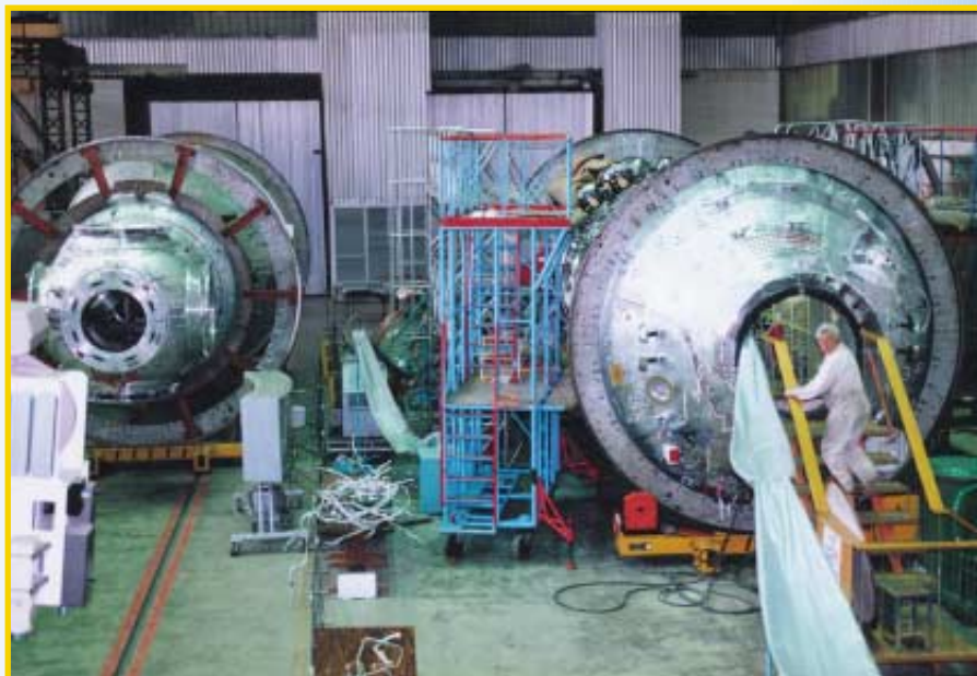
Корпус Служебного модуля (пока еще с 5-ю стыковочными узлами на ПХО) и корпус ФГБ. 1996 год
