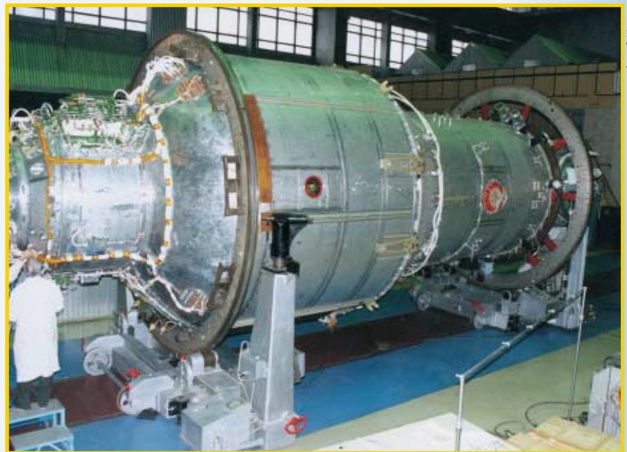
Служебный модуль на сборке. Агрегатного отсека еще нет. Осень 1997 г.
