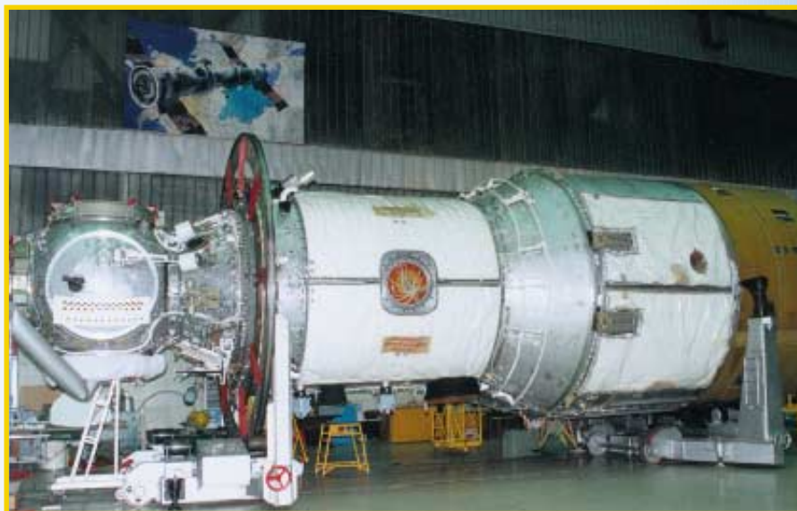
Служебный модуль в Центре Хруничева. Идет агрегатная сборка. Январь 1998 г.
