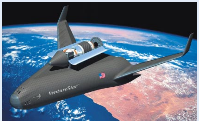
Новая концепция носителя VentureStar с внешним отсеком полезного груза
