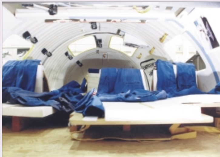
«Интерьер салона» пока еще прототипа аварийной шлюпки CRV
