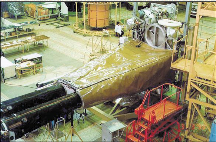
Сборка вибро-тепловой модели телескопа «Содарт» для проекта СРГ
