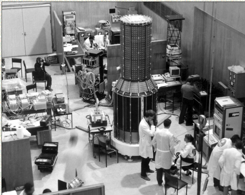
Наземные электрические испытания научной аппаратуры обсерватории «Гранат»
