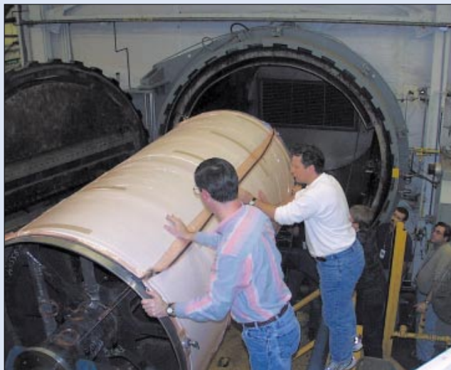
Установка обечайки бака X-34 в автоклаве
