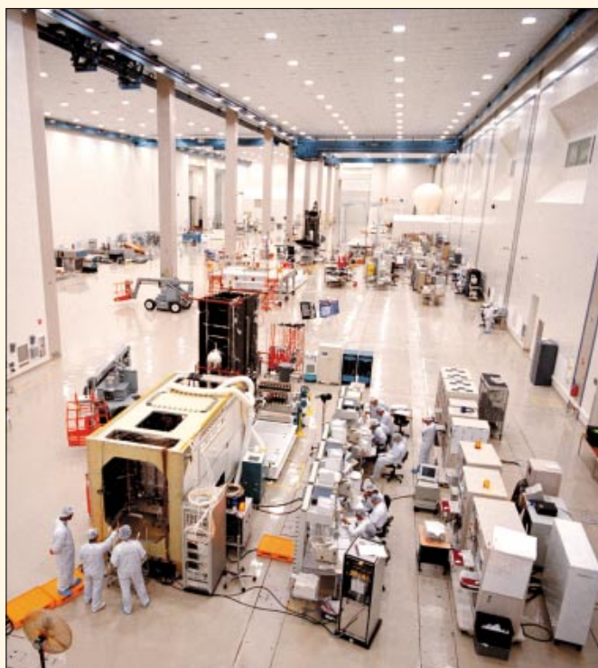
«Роддом» спутников А2100 – чистый зал сборки Коммерческого спутникового центра. Фото LMMS
