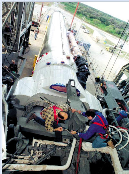
Первый РД-180 установлен на Atlas 3A №AC-201, планируемом для запуска КА связи с пускового комплекса 36В в апреле этого года
