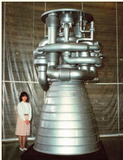
Один из предполагаемых виновников аварии Н-2 №8 – основной двигатель первой ступени LE-7. По сообщению [2], на видеозаписи старта были отмечены истекающие из него «аномальные струи газа», что дало основание высказать версию об утечке жидкого водорода
