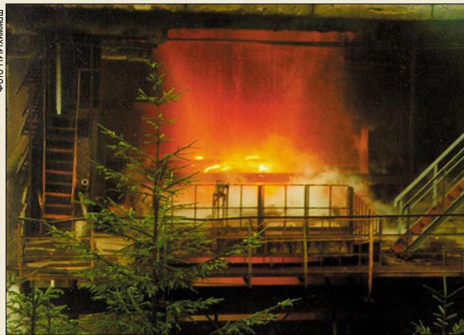
Огневые испытания двигателя РД-120К для носителя «Единство»
