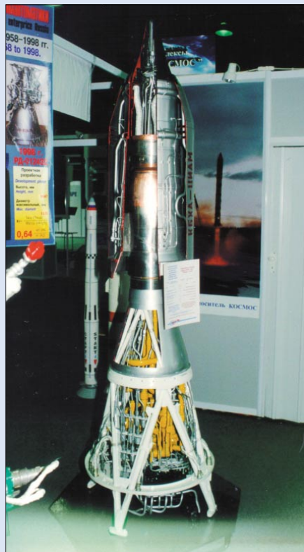
Экспериментальный ГПВРД разработки ЦИАМ и БХА, использованный в исследованиях по программе «Холод»
