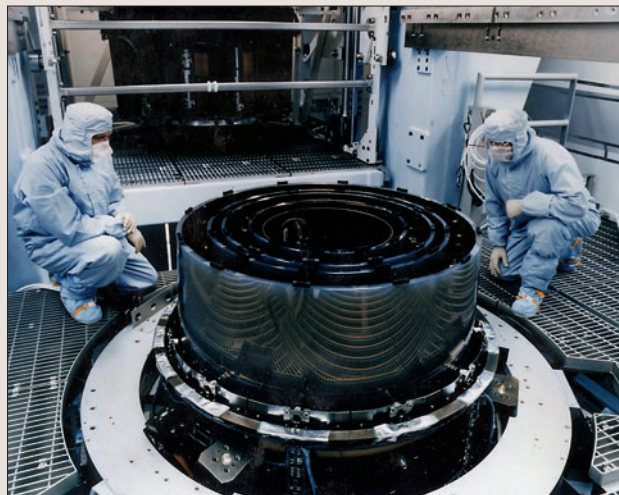
Система зеркал модуля высокого разрешения HRMA
