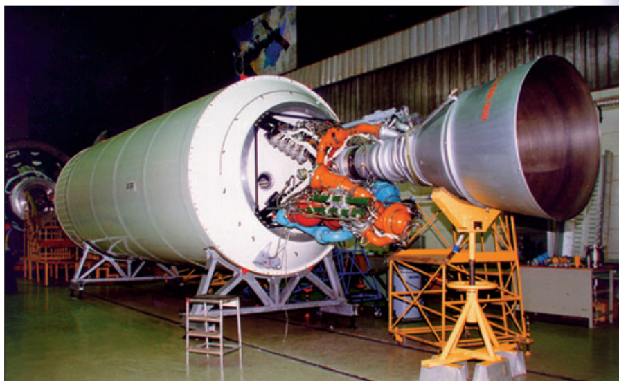
Бак горючего первой ступени с двигателем РД-191М (без хвостового отсека) РН «Ангара А-1.1»
