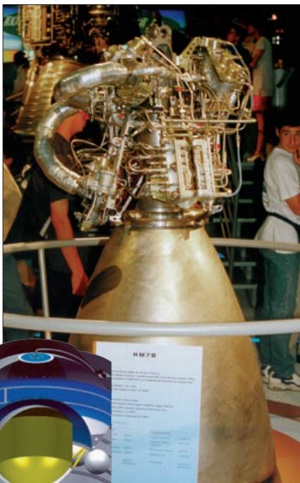
Двигатель HM-7B и схема криогенной верхней ступени ESC-A
