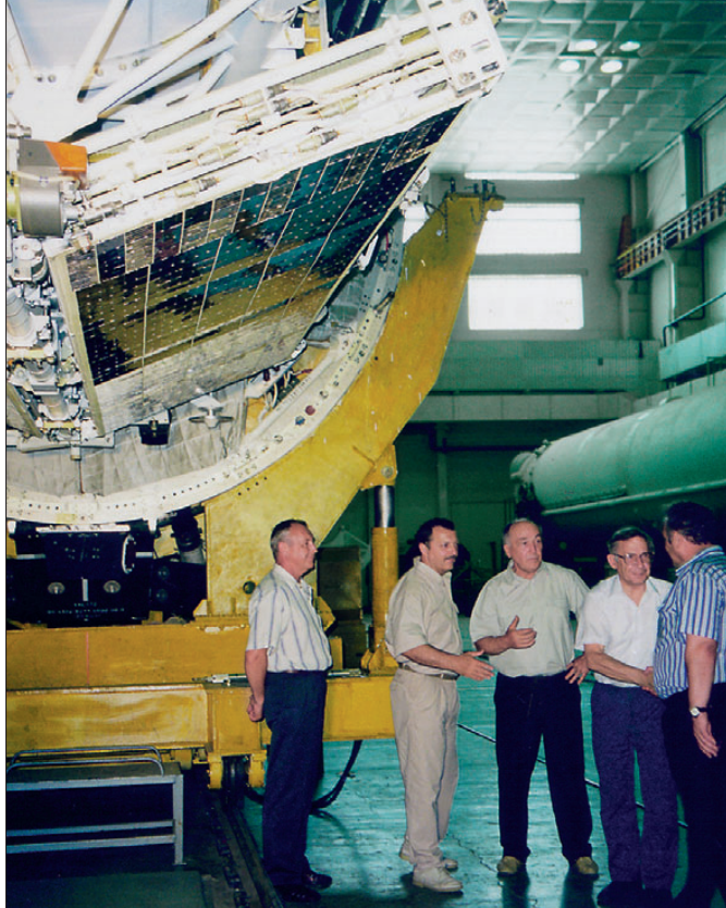
КА «Океан-О», пристыкованный к РН. Готовность к накатке обтекателя
