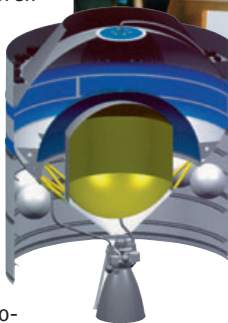
Двигатель HM-7B и схема криогенной верхней ступени ESC-A
