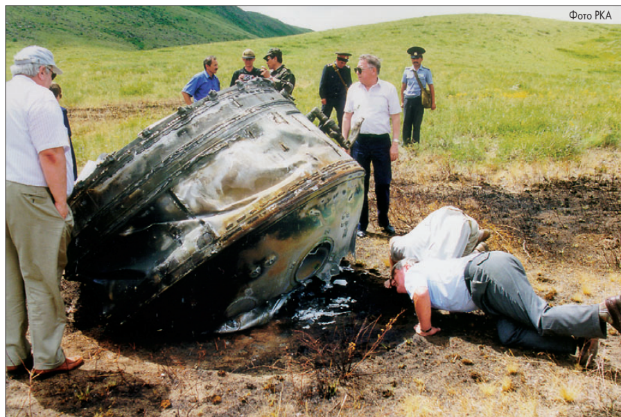
А.К.Недайвода (ГКНПЦ) и В.С.Рачук (КБХА) исследуют бак гептила РБ «Бриз», вызвавший загорание степи. Утечки гептила не обнаружено. Слева – Ю.Н.Коптев
