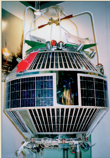
КА «Зeya», сделанный на базе аппарата «Стрела-1М»
