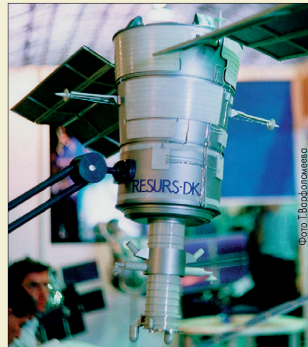
КА «Ресурс-ДК1», судя по всему, созданный на базе «Января-4КС»
