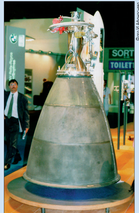
ЖРД Aestus, работающий на топливе «азотный тетроксид–монометилгидразин».
