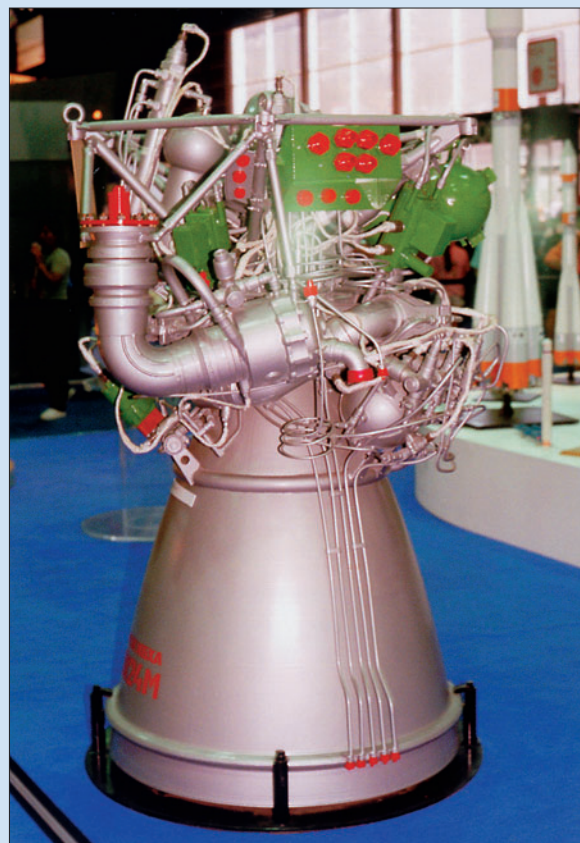
Однокамерный двигатель РД-0124М для «Руси»
