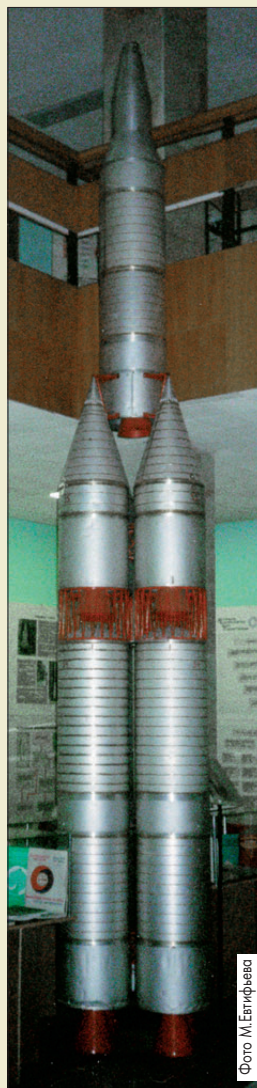
Динамически подобная модель пятиблочной Р-56 в музее ЦНИИМаш
