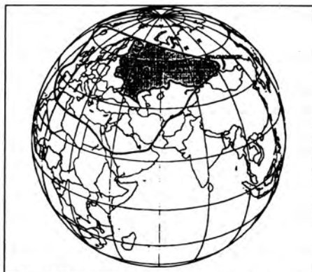
Рис.1. Схема охвата фиксированным лучом SESat. Материалы PKA и Eutelsat, 1996.
