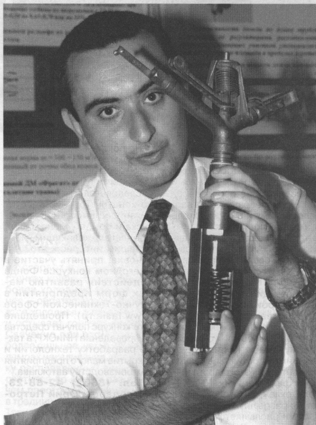
Регулятор давления воды.
