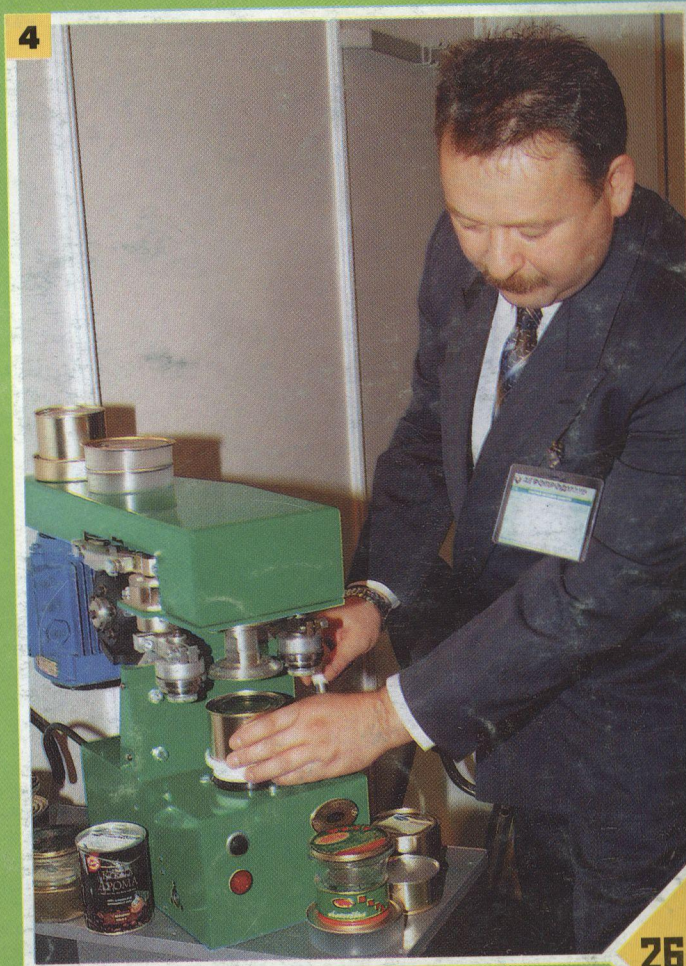
1. Руки можно мыть не прикасаясь ими к кранам: полная стерильность. 2. Открывалка для пластиковой тары. 3—4. Вакуумный и обычный консервные «микроразводики».
