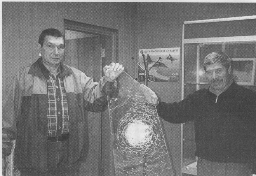
О.Ачкасов (слева) и один из авторов, зам.директора НИИ технического стекла Ю.Машир демонстрируют непробиваемость вертолетных стекол.
