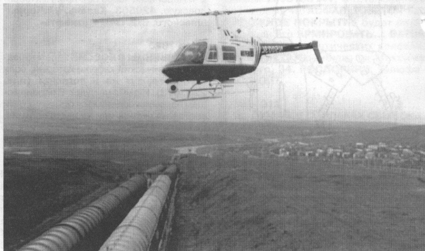
Воздушный способ контроля позволяет за один полет проверить работу многокилометровых участков трубопроводов.
