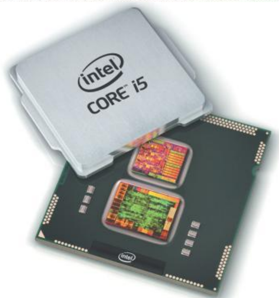
У процессоров Clarkdale контроллер памяти вынесен на отдельный кристалл, и это плохо сказывается на эффективности контроллера.
