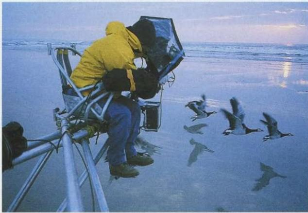
Кресло оператора закреплено на подвижном кране, которым оборудована едущая вдоль берега машина. Маневренность крана позволяет проводить панорамные съемки.
