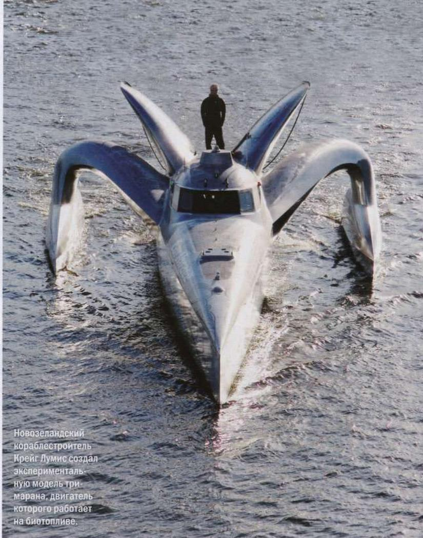
Новозеландский кораблестроитель Крейг Лумис создал экспериментальную модель тримарана, двигатель которого работает на биотопливе.
