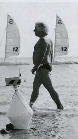
Специальный буй, издающий звуковые сигналы, помогает слепым ориентироваться в море.
