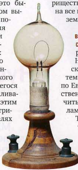
Одна из первых лампочек Томаса Эдисона (1879 год). Изготовлена из стекла и дерева
