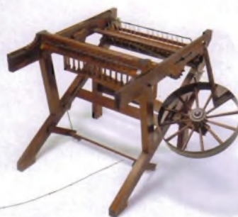
Одна из модификаций прядильной машины, изобретенной около 1765 года английским ткачом Джеймсом Харгривсом
