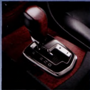
Новая 6-ступенчатая АКПП с электронным управлением и овердрайвом
