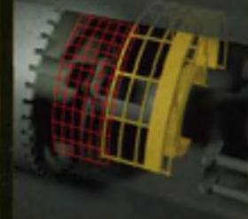
Стальные решетки и кольцеобразные конструкции надежно защищают только что пробуренный ход от обвала
