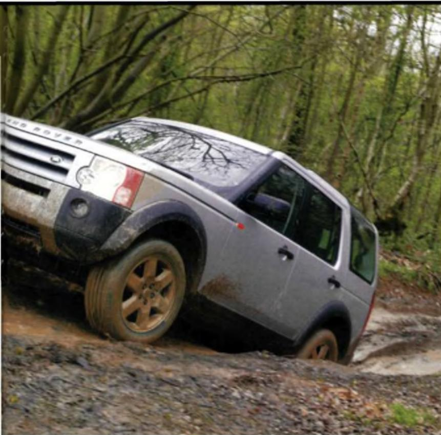
**Управляемые электроникой пневмоэлементы всех четырех колес помогают поддерживать клиренс Land Rover Discovery 3 ПОСТОЯННЫМ независимо от загрузки. Система управления пневмоподвеской может увеличивать ходы подвесок при движении по пересеченной местности**
