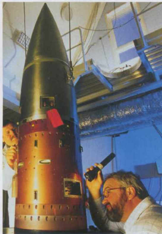
Слева: экспериментальные образцы помещают в головную часть «Тексуса» прямо перед стартом. Справа: головную часть пристыковывают к нижним ступеням ракеты
