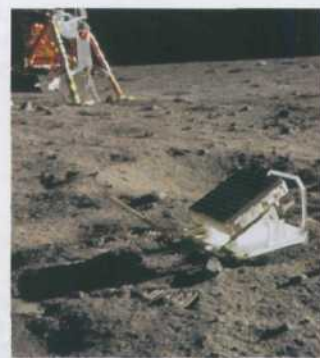
Лазерные отражатели, установленные в 1969 г. на Луне, используются для измерения расстояния до Земли
