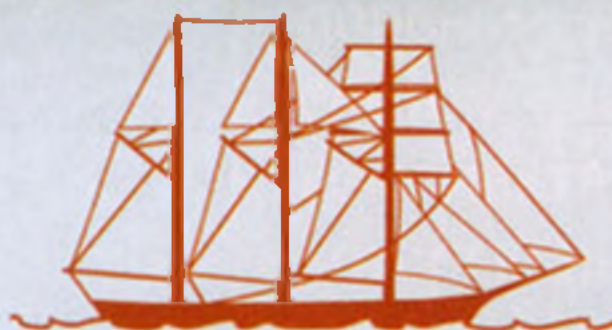
МАРСЕЛЬНАЯ ШХУНА ДЖЕКАСС три мачты с косыми парусами и прямые паруса на фок-мачте
