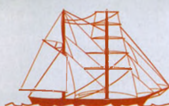
БРИГАНТИНА шхуна-бриг: одна мачта с косыми парусами и одна с прямыми
