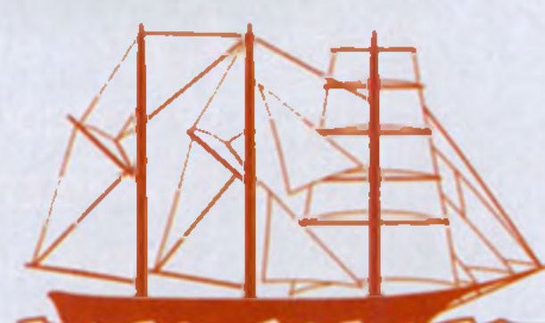
БАРКЕНТИНА шхуна-барк: две мачты с косыми парусами, одна мачта с прямыми
