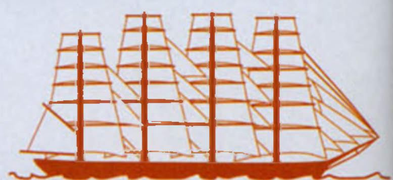
ЧЕТЫРЕХМАЧТОВЫЙ КОРАБЛЬ четыре мачты с прямыми парусами (есть пятимачтовый тип)
