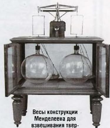
Весы конструкции Менделеева для взвешивания твердых и газообразных веществ
