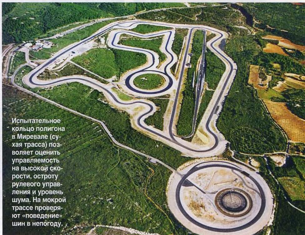
Испытательное кольцо полигона в Миревале (сухая трасса) позволяет оценить управляемость на высокой скорости, остроту рулевого управления и уровень шума. На мокрой трассе проверяют «поведение» шин в непогоду.
