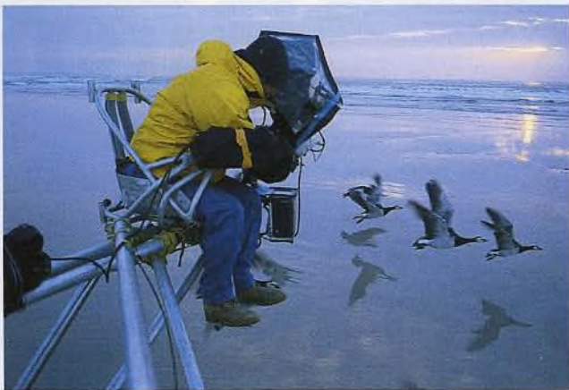
Кресло оператора закреплено на подвижном кране, которым оборудована едущая вдоль берега машина. Маневренность крана позволяет проводить панорамные съемки.
