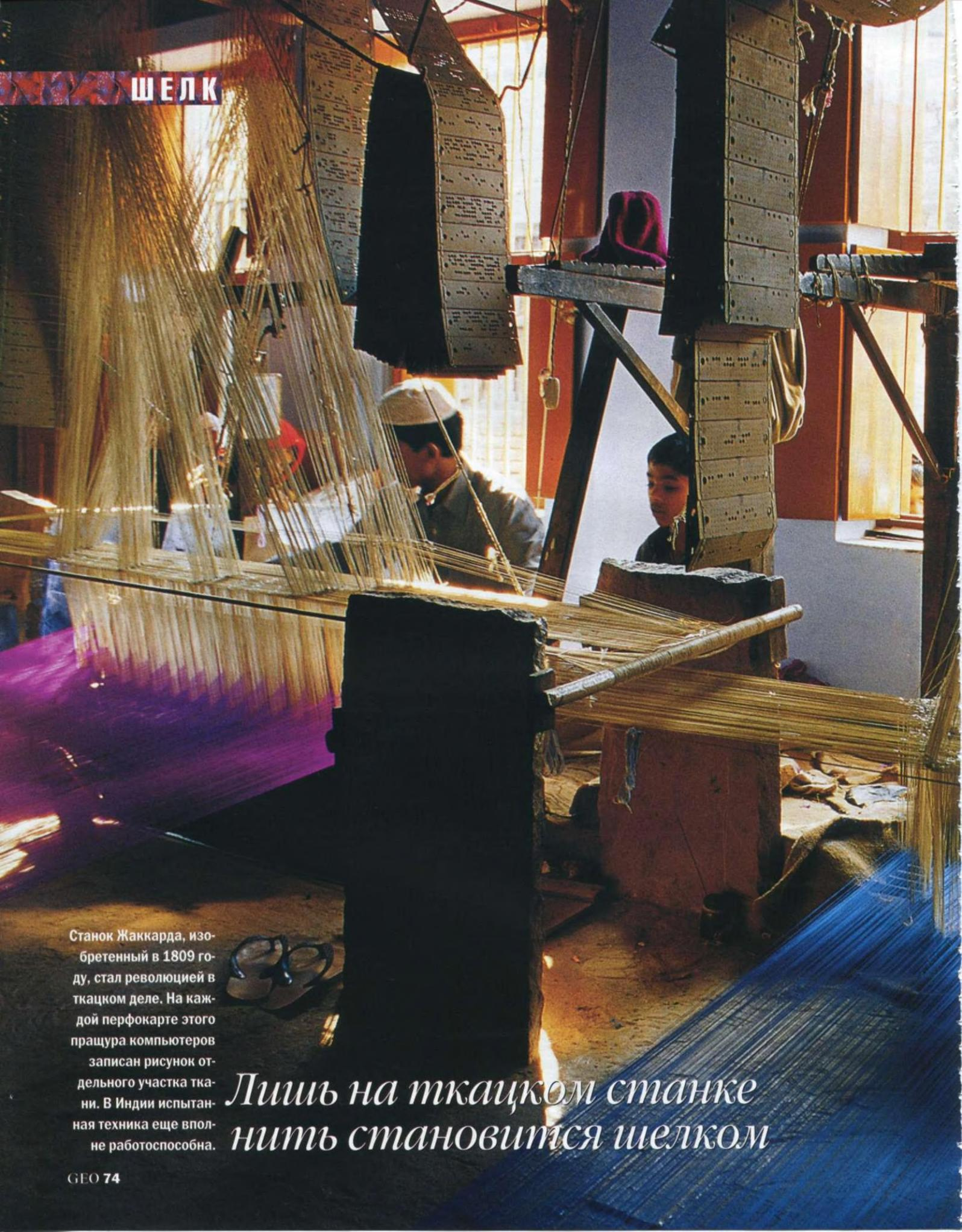
Станок Жаккарда, изобретенный в 1809 году, стал революцией в ткацком деле. На каждой перфокарте этого прасура компьютеров записан рисунок отдельного участка ткани. В Индии испытанная техника еще вполне работоспособна.
