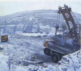
Мощные экскаваторы загружают алмазную породу в самосвалы грузоподъемностью 120–136 тонн.
