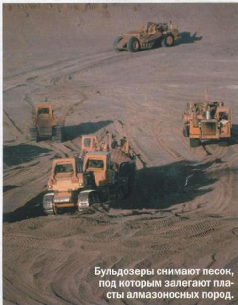
Бульдозеры снимают песок, под которым залегают пласты алмазоносных пород.
