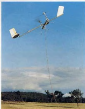
Испытательный полет летающего электрогенератора.
