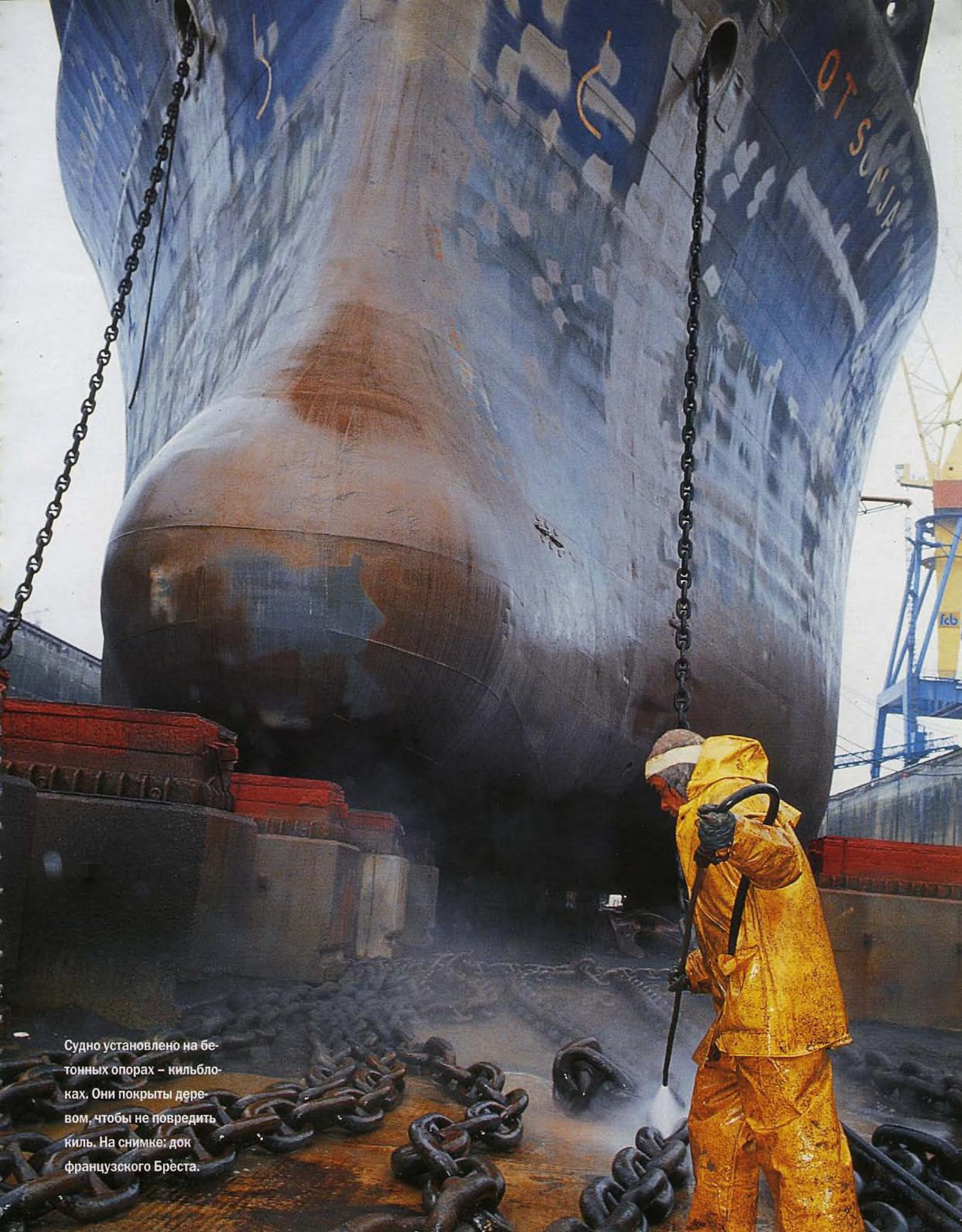
Судно установлено на бетонных опорах – кильблоках. Они покрыты деревом, чтобы не повредить киль. На снимке: док французского Бреста.
