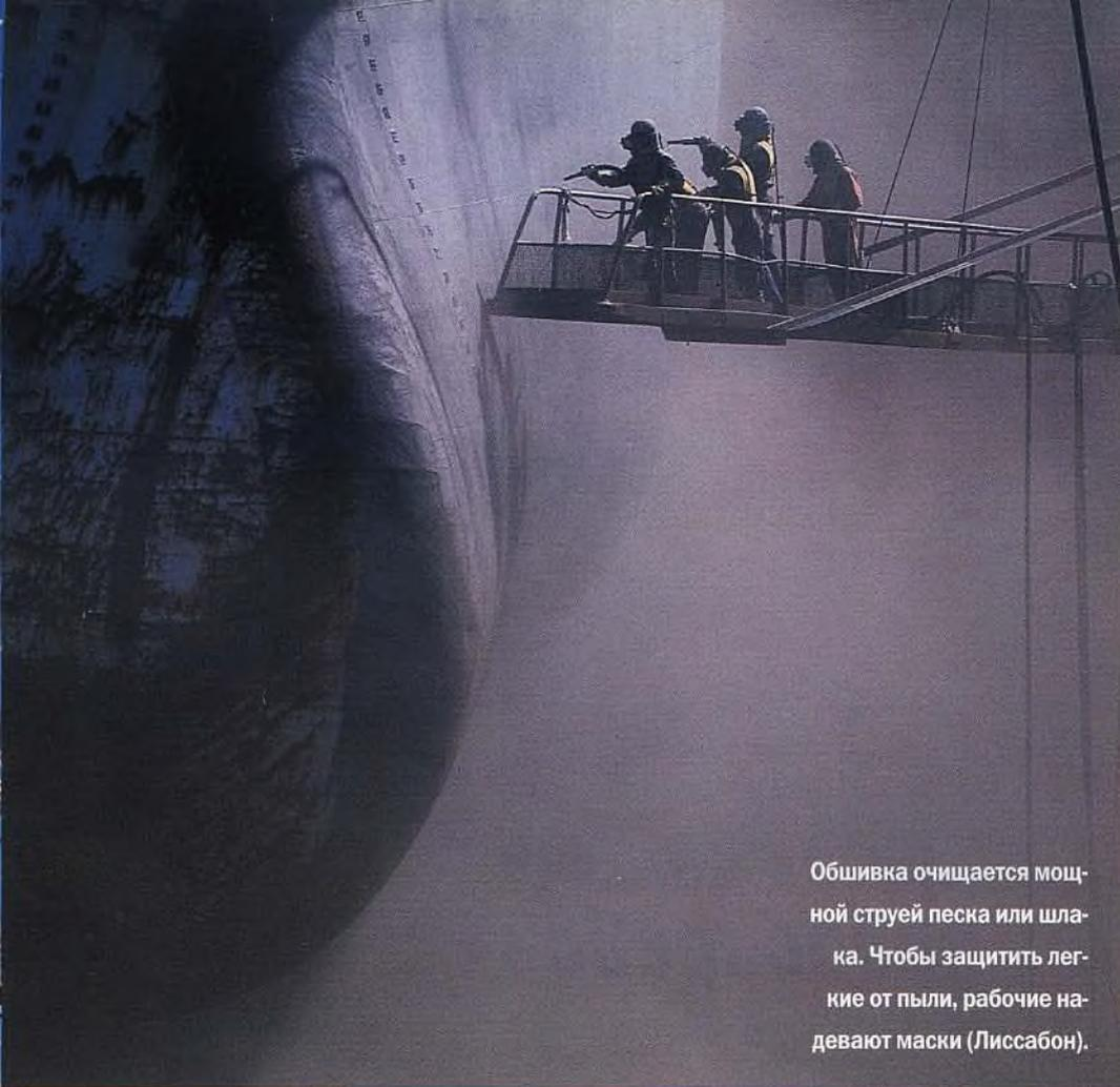
Обшивка очищается мощной струей песка или шлака. Чтобы защитить легкие от пыли, рабочие надевают маски (Лиссабон).
