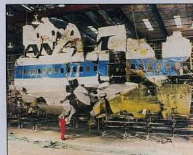
**Эксперты изучили каждый обломок – вплоть до крошечного осколка радиоприемника (вверху). Остатки той части фюзеляжа, где взорвалась бомба, крепились на трехмерный каркас (внизу).**
