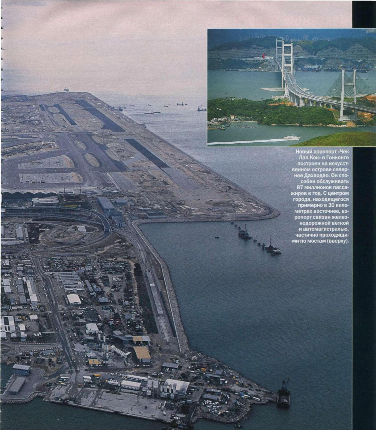
Новый аэропорт «Чек Лап Кок» в Гонконге построен на искусственном острове севернее Дахаодао. Он способен обслуживать 87 миллионов пассажиров в год. С центром города, находящегося примерно в 30 километрах восточнее, аэропорт связан железнодорожной веткой и автомагистралью, частично проходящими по мостам (вверху).
