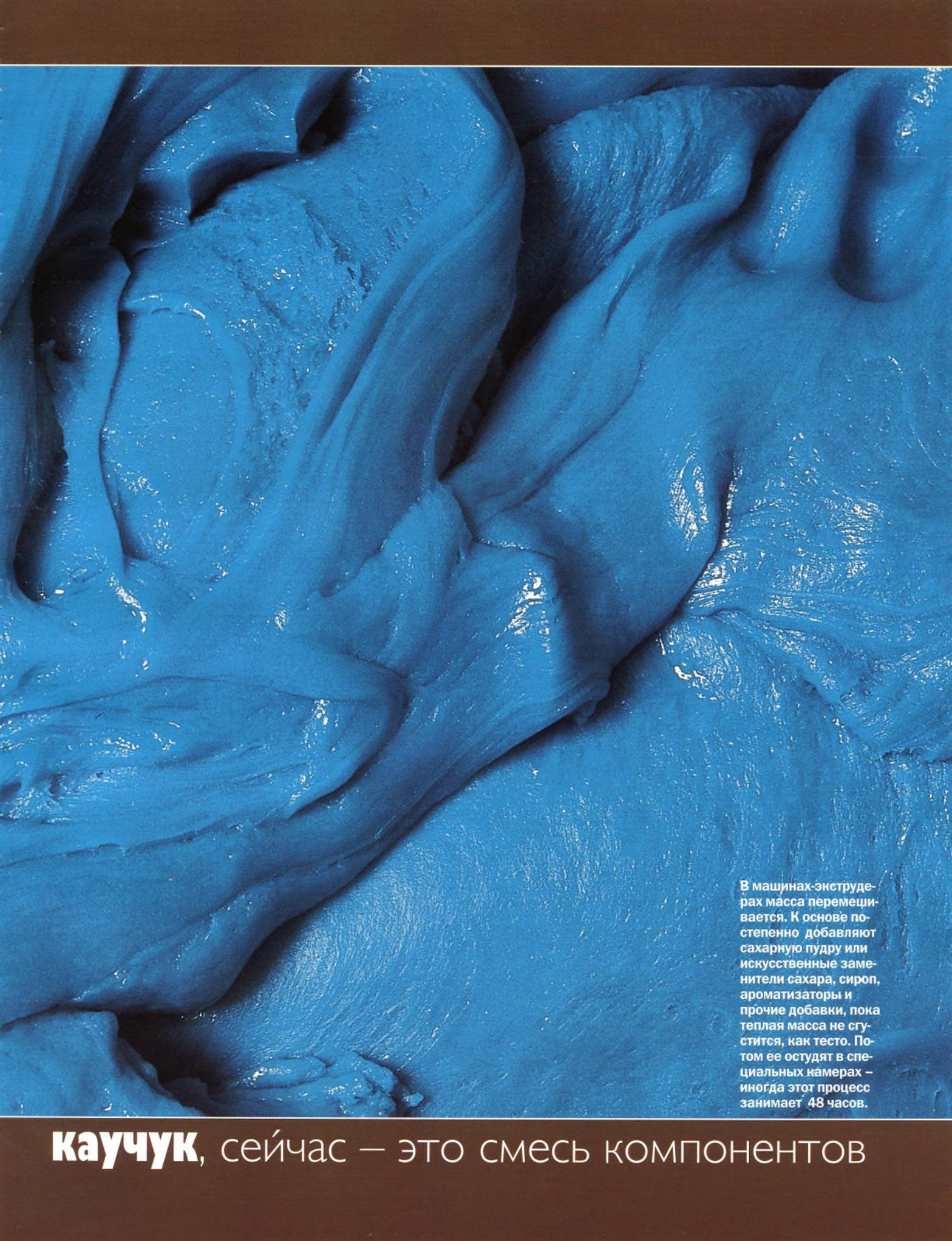
В машинах-экструдерах масса перемещается. К основе постепенно добавляют сахарную пудру или искусственные заменители сахара, сироп, ароматизаторы и прочие добавки, пока теплая масса не сгустится, как тесто. Потом ее охладят в специальных камерах – иногда этот процесс занимает 48 часов.
