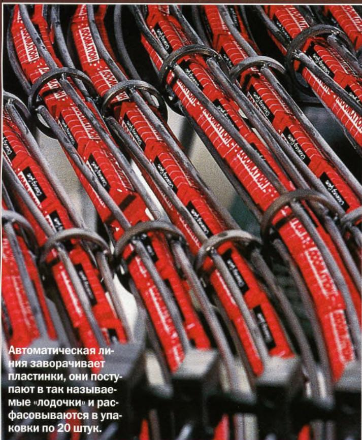
Автоматическая линия заворачивает пластинки, они поступают в так называемые «лодочки» и расфасовываются в упаковки по 20 штук.
