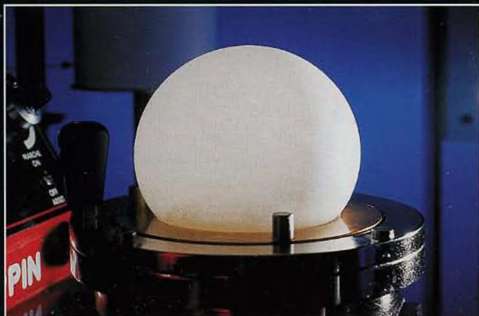
Еще до замешивания специалисты берут образцы теста и на испытательном стенде надувают их, словно пузырь жевательной резинки. Так тесто проверяется на эластичность и прочность.
