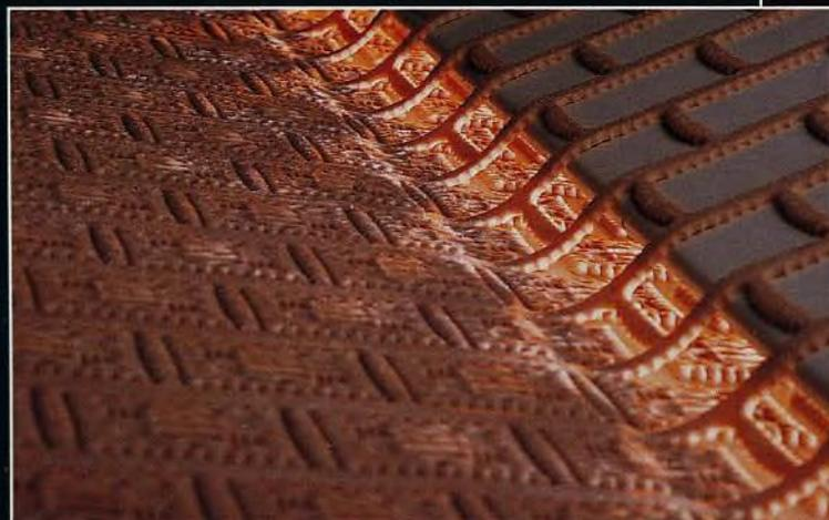
После формовки заготовки по конвейеру попадают в печь. Остатки теста (узорчатая решетка в правом верхнем углу снимка) снова идут в производство.
