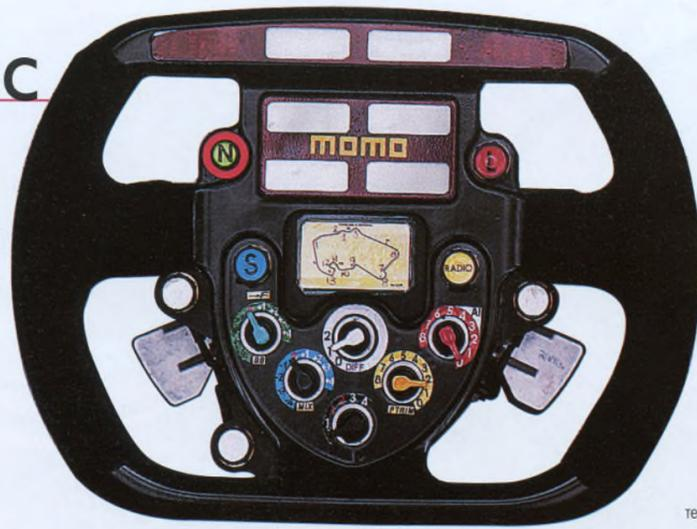
**Рулевое колесо** Экономия места заставляет конструкторов переносить приборы и датчики на руль. На руле Ferrari размещены шесть жидкокристаллических информационных экранов, кнопки сцепления, радиосвязи, регуляторы работы двигателя, трансмиссии, тормозов.
