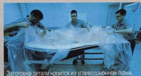
Заготовка детали кроится из углеволоконной ткани.
