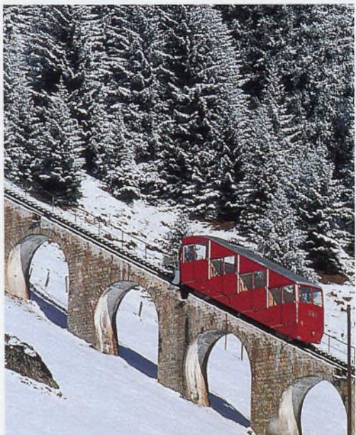
Одна из старейших разновидностей канатного транспорта – фуникулер: несущий канат проложен между рельсами пути, по которому в противоположных направлениях едут вагоны. Чтобы они могли разминуться, посередине трассы есть специальное расширение.
