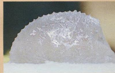
Диаметр керна – сто миллиметров, себестоимость погонного метра – 500 долларов. Волнистый край – следы термобуровой коронки.
