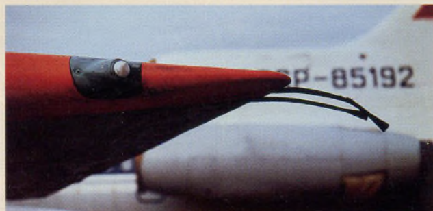
Сгоревший после удара молнии разрядник статического электричества – своего рода «авиационный громоотвод».
