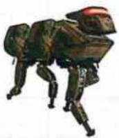
**Boston Dynamics** – американская компания, специализирующаяся на робототехнике. Среди разработок компании – четвероногий робот BigDog, способный перемещать груз до 154 кг, создававшийся как вспомогательное транспортное средство для передвижения сухопутных войск по труднопроходимой местности.
