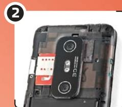
Для съемки 3D-видео в смартфоне используются две 5-мегапиксельные камеры, в 2D-режиме активируется только одна из них
