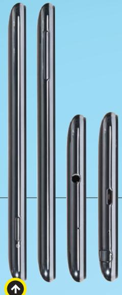
На нижнем торце смартфона расположены Micro-USB, отверстие для микрофона и перо. На верхнем – аудиоразъем и второй микрофон. По бокам – кнопка включения и сдвоенная клавиша громкости
