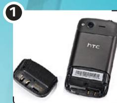
Корпус Desire S выполнен из цельного куска алюминия с двумя вставками из софт-тач-пластика
