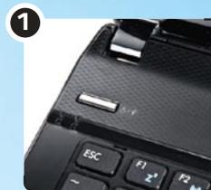
1 Симметричная кнопка включения клавиша позволяет менять профили производительности/энергопотребления ASUS Super Hybrid Engine
