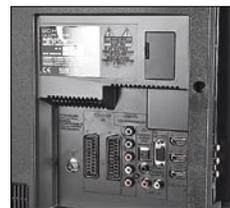
Значительная толщина корпуса облегчает подключение устройств при монтировании ТВ на стену
