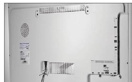
Из-за малой толщины корпуса при монтаже на стену доступ к разъемам будет затруднен
