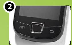
Клавиши на лицевой панели только кажутся сенсорными, на самом деле они механические
