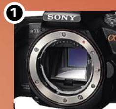
**1** Полупрозрачное неподвижное зеркало позволяет камере снимать со скоростью до 10 кадров/с, а также использовать фазовую фокусировку в режиме Live view и при съемке видео
