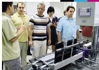
Китайский специалист по контролю рассказывает о нюансах тестирования прочностных характеристик ноутбуков в одной из лабораторий завода в Сучжоу
