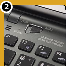
2 Трехпозиционный переключатель в верхней части рабочей панели переводит гибридную графику в интегрированный, дискретный или автоматический режим
