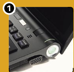
1 Прозрачная кнопка включения, размещенная на торце характерного трубчатого шарнира, в активном режиме подсвечивается ярким зеленым светодиодом
